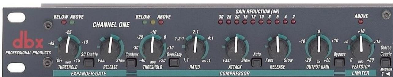
Von links nach rechts: Die Regler Threshold und Release sowie der Schalter SC Enable gehören zum Gate. Man stellt mit Threshold die Schwelle ein, unterhalb der abgeriegelt werden soll, so dass z.B. leises Rauschen nicht zum Ausgang durchkommt, falls sonst
